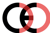
Faux marquage CE (trop proche)
