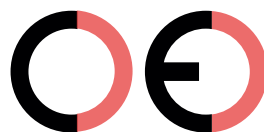
Faux marquage CE (trop éloignée)
